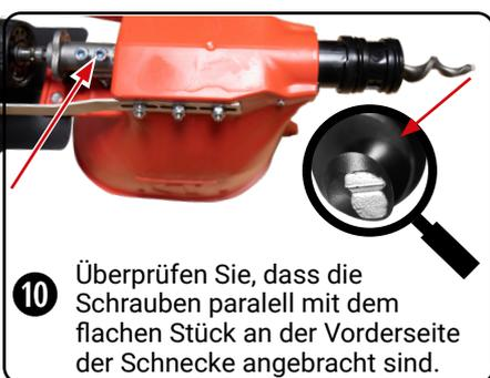
**10** Überprüfen Sie, dass die Schrauben parallel mit dem flachen Stück an der Vorderseite der Schnecke angebracht sind.
