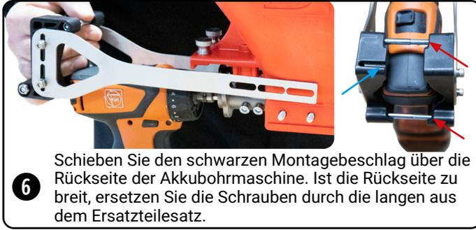
**6** Schieben Sie den schwarzen Montagebeschlag über die Rückseite der Akkubohrmaschine. Ist die Rückseite zu breit, ersetzen Sie die Schrauben durch die langen aus dem Ersatzteilesatz.
