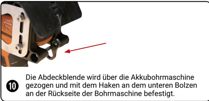
**10** Die Abdeckblende wird über die Akkubohrmaschine gezogen und mit dem Haken an dem unteren Bolzen an der Rückseite der Bohrmaschine befestigt.
