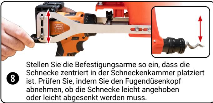
**8** Stellen Sie die Befestigungsarme so ein, dass die Schnecke zentriert in der Schneckenkammer platziert ist. Prüfen Sie, indem Sie den Fugendüsenkopf abnehmen, ob die Schnecke leicht angehoben oder leicht abgesenkt werden muss.
