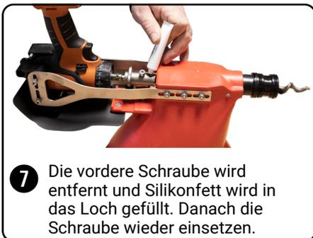
**7** Die vordere Schraube wird entfernt und Silikonfett wird in das Loch gefüllt. Danach die Schraube wieder einsetzen.
